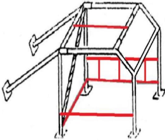
Die Abbildung zeigt die mind. Anforderung an den Überrollkäfig des Fahrzeuges, weitere Verstreben zur Sicherheit des Fahrers sind erlaubt. Seit 01.01.2016 sind die Verstreben Seitenaufprallschutz in Skizze rot Pflicht.
